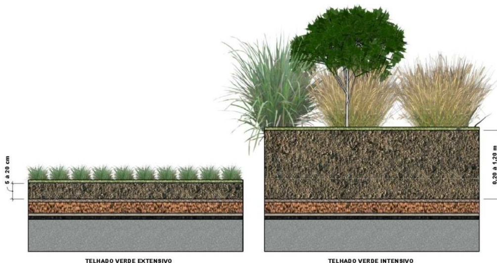
Figura 046 – Comparação entre os telhados verde extensivo e intensivo Fonte: Autor
