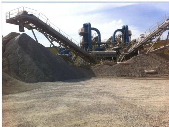
**Figura 21 - Fotografia das esteiras e dos montes de AR na usina de reciclagem de Grajaú.**
