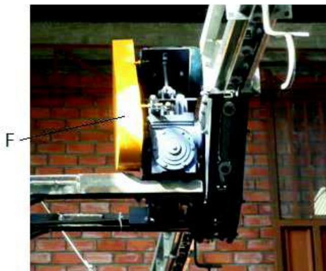
Figura 6: Proteção da transmissão de força polias/correia
