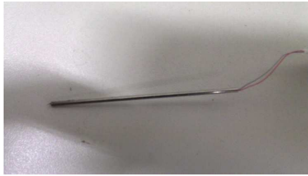
Figura 3.8- Termopar encapsulado com tubo de aço inoxidável de 1,6 mm de diâmetro por 55 mm de comprimento.
