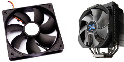
Figura 2.2- (a) Ventilador e (b) ar – cooler .
