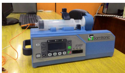
Figura 3.10- Bomba de seringa para injeção do líquido no dissipador e controle de vazão.
