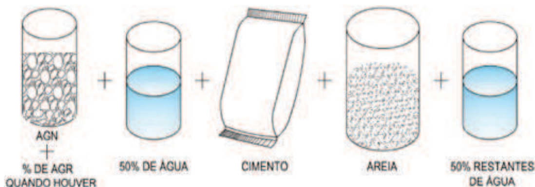
Figura 9 - Ordem de inserção dos materiais na betoneira
