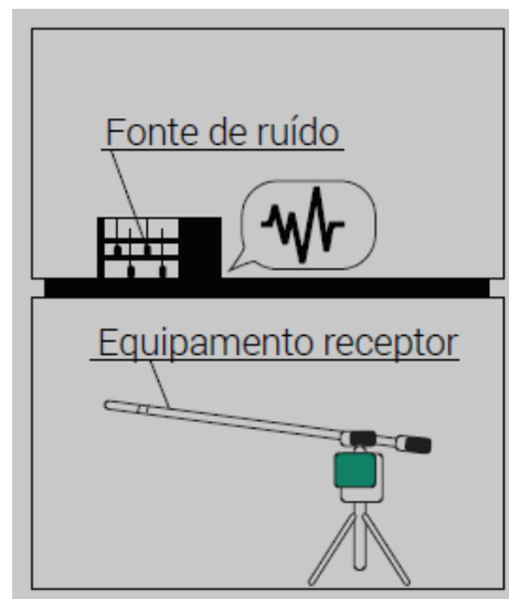
Figura 6 - Medição do isolamento ao ruído de impacto
