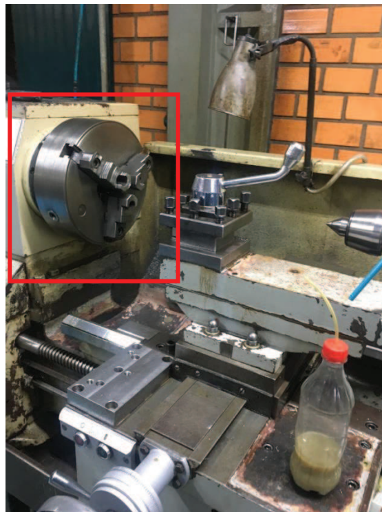
Figura 4- Placa do torno L-2680
