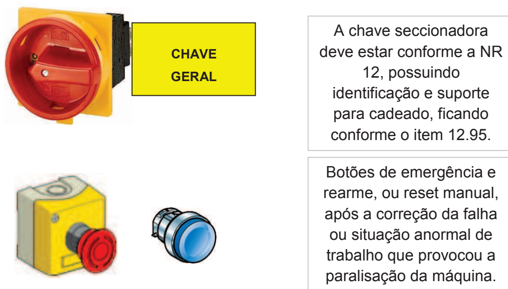
Figura 13 – Chave geral, botão de emergência, e reset manual
