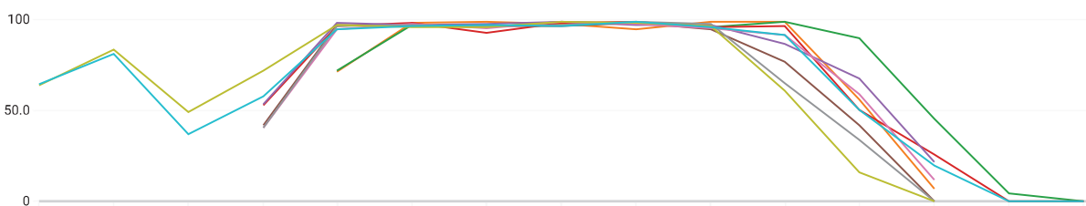
Figura 46 – Consumo percentual de CPU para cada VM envolvida na execução do arquivo 12-stamatakis-59 no cenário C_{c36} , onde cada linha representa uma VM ativa com quatro cores de processamento.
