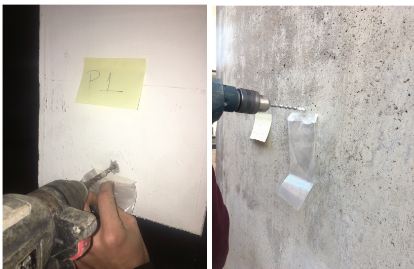
Figura 21- Processo de furação com broca de 8mm e embalagem ziplock para coleta de amostra
