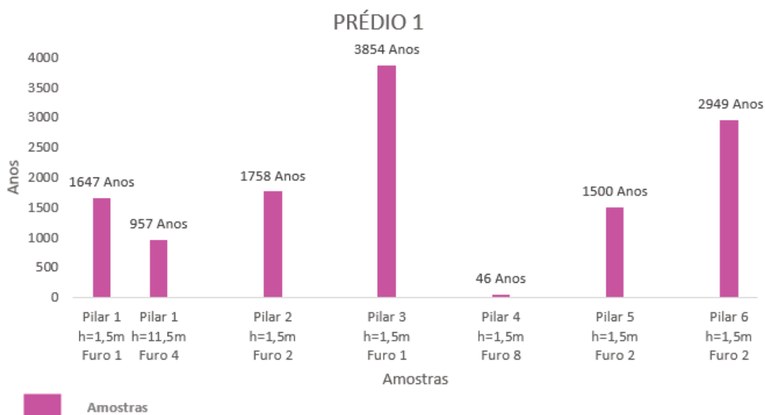
Gráfico 5: Vida residual dos pilares de amostragem do edifício Prédio 01.
