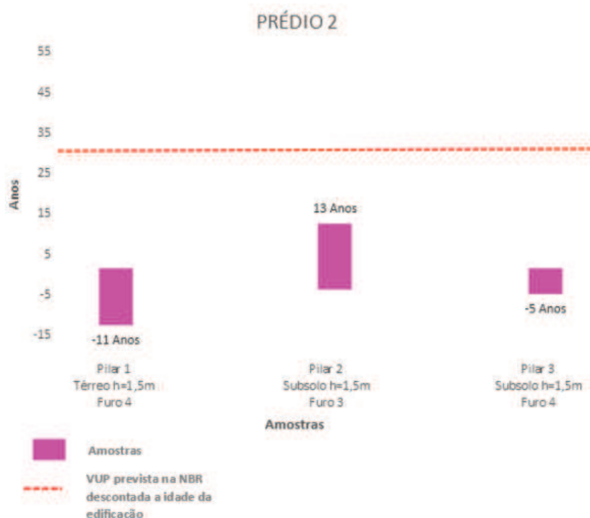
Gráfico 6 - Vida residual dos pilares de amostragem do edifício Prédio 02.
