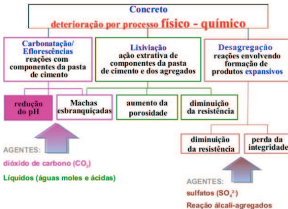
Figura 2 - Deterioração do concreto por processo físico-químico
