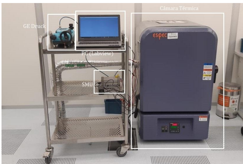
Figura 39 – Equipamentos e estrutura montada para realizar os testes das amostras de sensor de pressão
