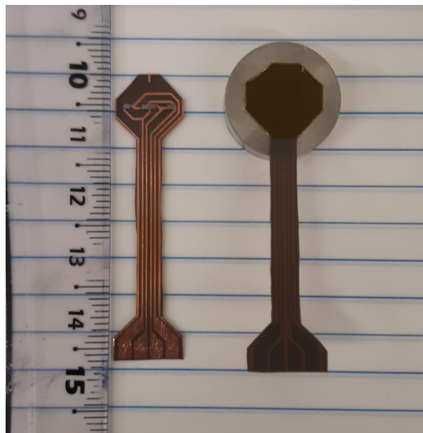
Figura 35 – Placa flexível para conexão dos piezoresistores e placa flexível já fixada à membrana de deformação
