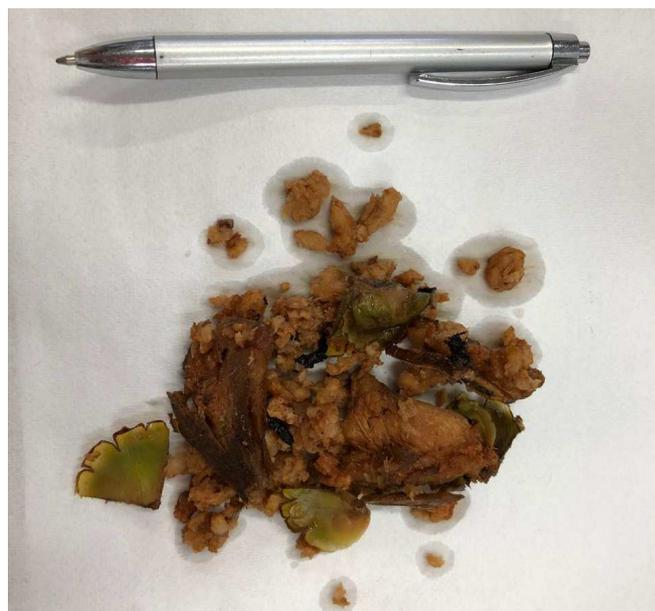
Figura 23 – Partículas de coco verde após a prensagem.
