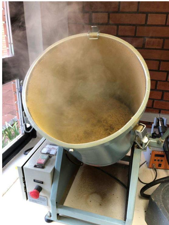
Figura 31 – FC e PLA após a homogeneização.
