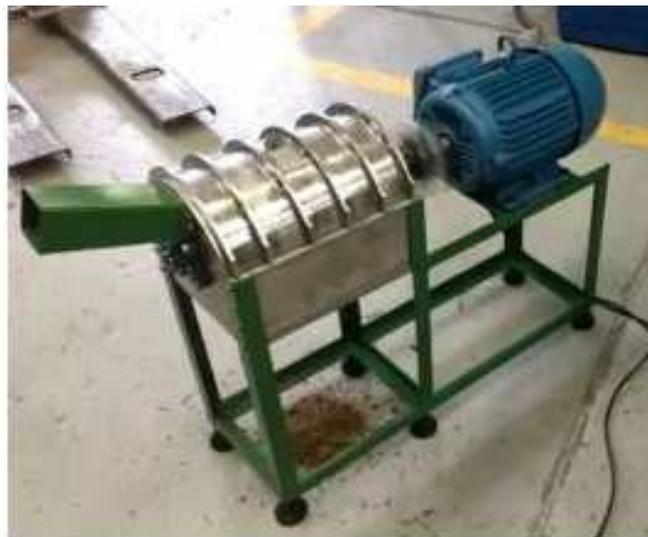
Figura 24 – Desfibrador mecânico.
