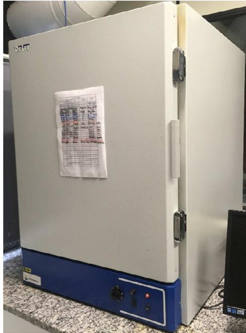
Figura 27 – Estufa para secagem das fibras.
