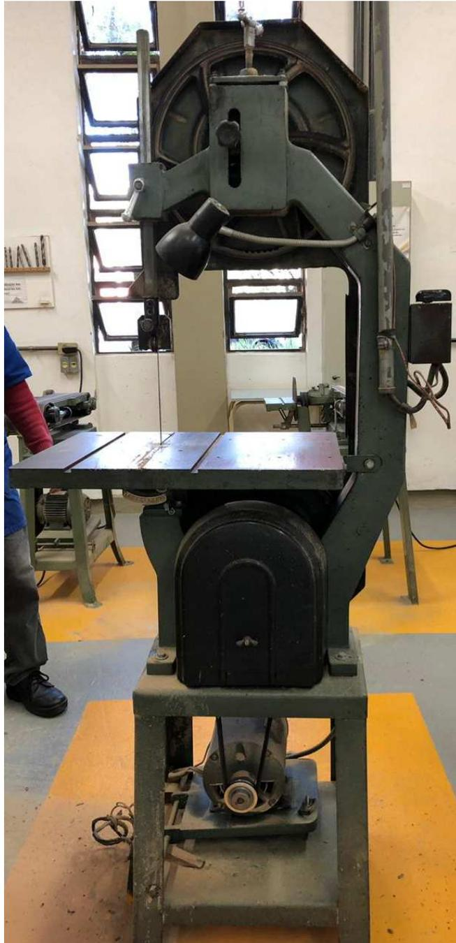
Figura 19 – Serra Fita utilizada para o corte dos cocos.
