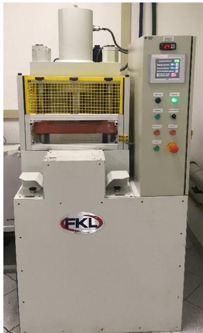
Figura 35 - Prensa hidráulica utilizada no processo de moldagem.
