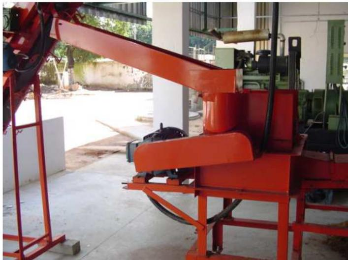
Figura 3 – Equipamento triturador da biomassa de coco.
