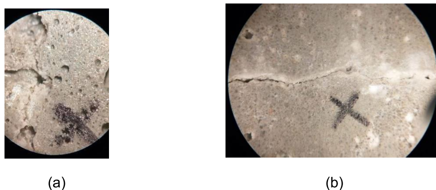
Figura 93 – Indícios da cicatrização de amostra PC15.R.CS.7d, análise aos 84 dias (a) acúmulo na superfície (b) produto na borda interna da fissura
