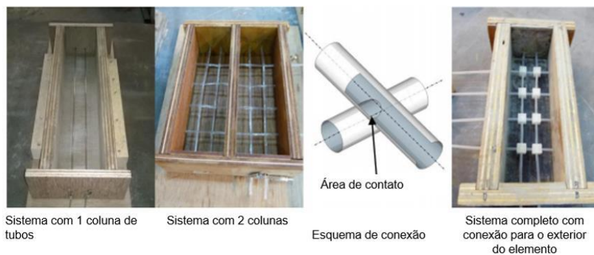
Figura 17 – Sistema de conexão - disposição dos microvasos ao longo do elemento de concreto
