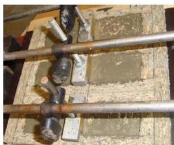
Figura 18 – Dispositivo com placas metálicas para a produção de fissuras no estado fresco
