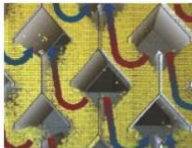
Figura 22 – Fluxo de ar em um secador de cavaletes
