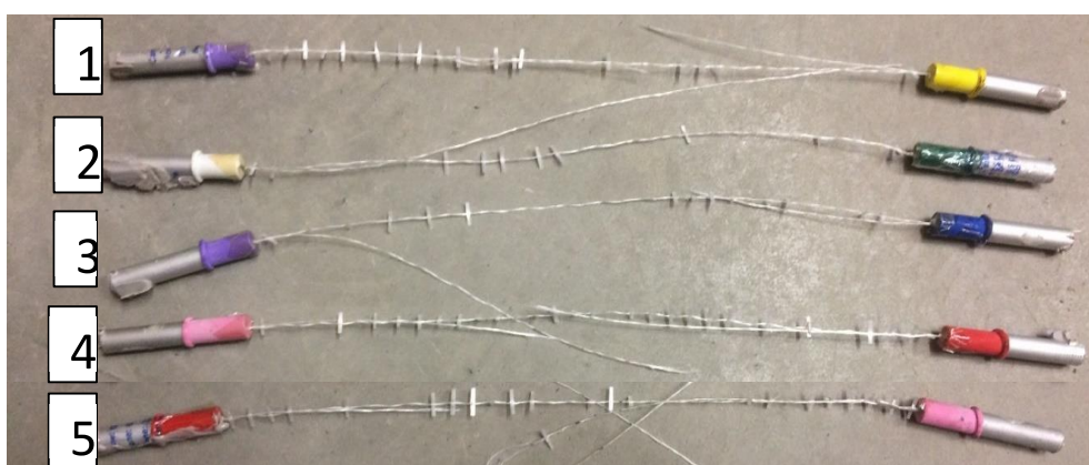
Figura 44 – Estado de ruptura dos corpos de prova após ensaio na direção da urdidura
