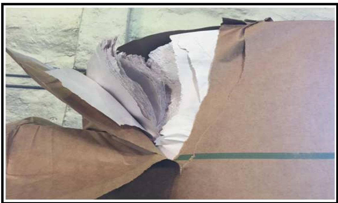
Figura 10 - Bobina avariada por queda
