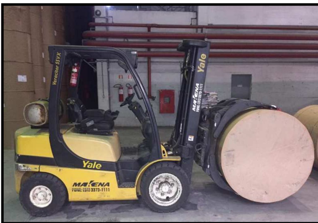
Figura 22 - Conjunto empilhadeira + “clamp”
