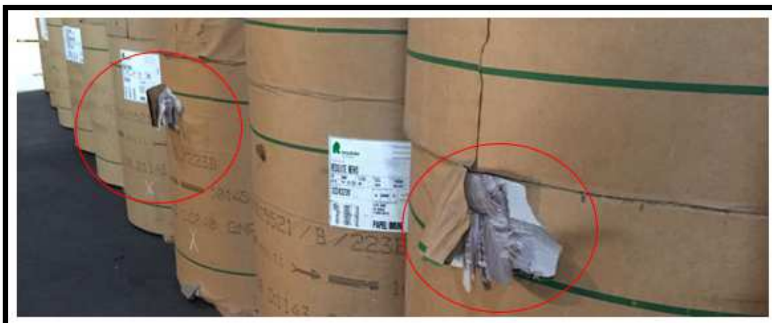
Figura 9 - Bobina avariada por colisão
