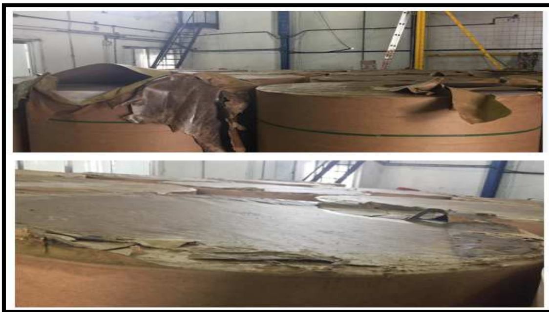
Figura 7 - Bobinas com umidade em destaque
