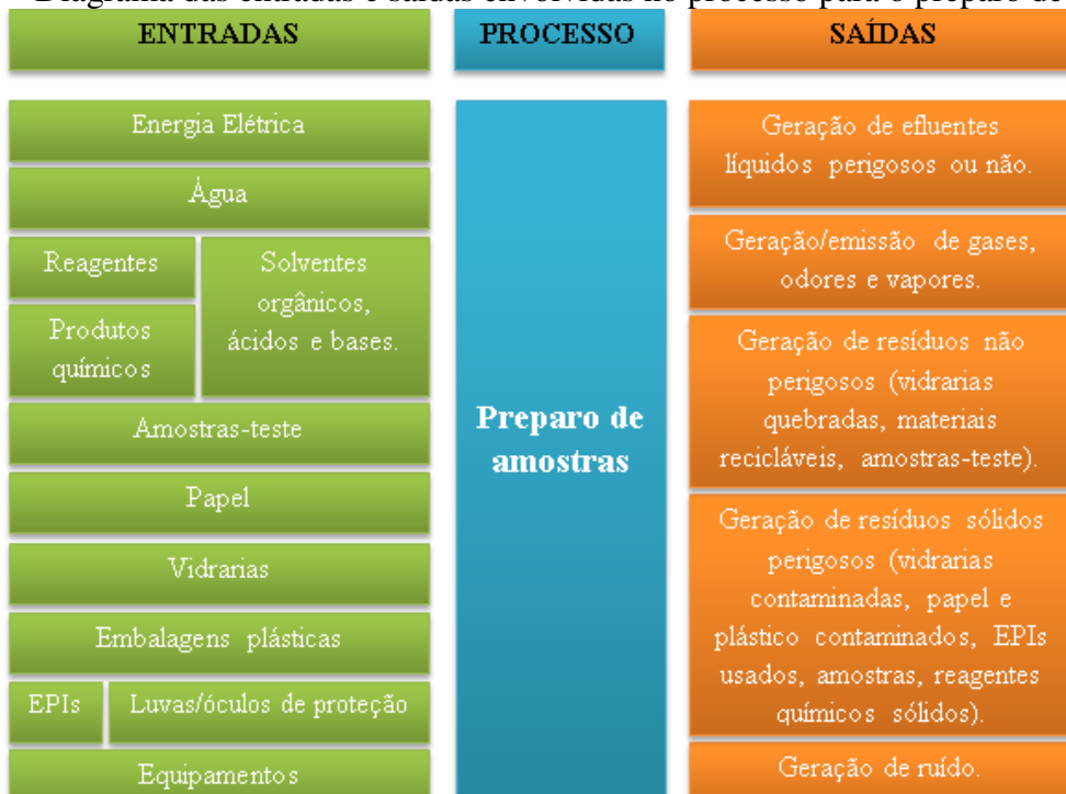
Figura 4 – Diagrama das entradas e saídas envolvidas no processo para o preparo de amostras
