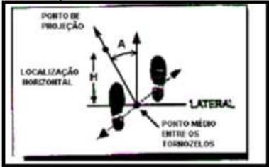
Diagrama de rotação do tronco. O ponto de projeção é o ponto médio entre os ombros. A localização horizontal é a distância lateral do ponto de projeção ao objeto.
