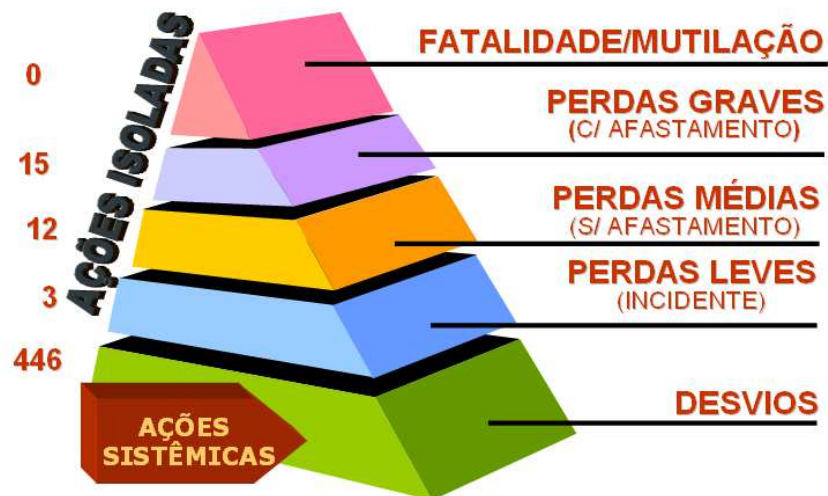
FIGURA 26: Pirâmide STIHL segundo modelo de Frank Bird , para o ano de 2011. FONTE: STIHL 2011
