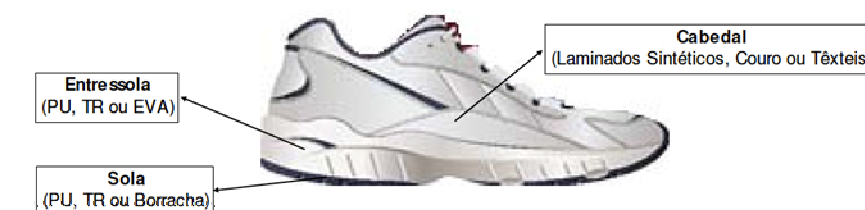
Figura 4. Principais partes e principais materiais utilizados na confecção de calçados
