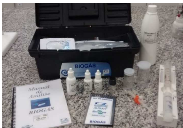
Figura 15 – Kit para execução de análise do biogás da EMBRAPA fornecido pelo Laboratório de Saneamento da UNISINOS
