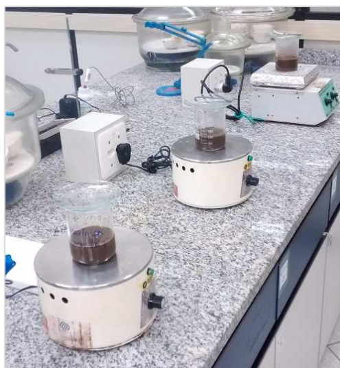
Figura 14 – Processo de agitação das amostras na determinação de AGV e alcalinidade
