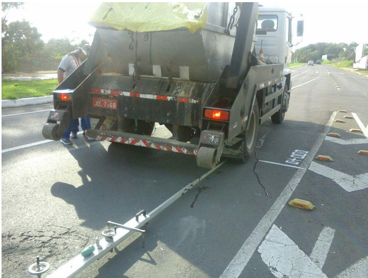
Figura 15 – Ensaio com viga Benkelman
