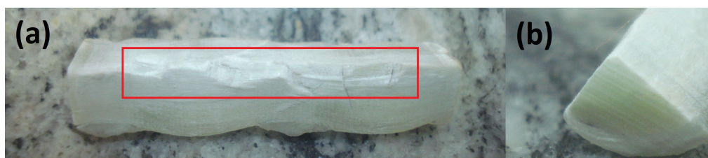
Figura 27 – Foto da amostra de GFRP (a) Detalhe nas regiões onde foram coletados materiais para as análises; (b) Detalhe seção transversal preparada.
