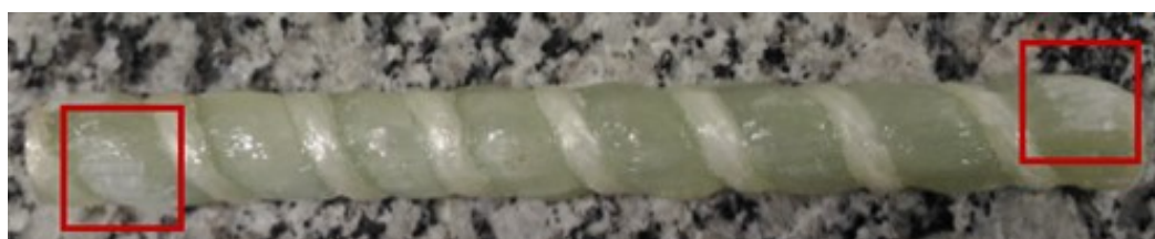
Figura 26 – Foto da amostra de GFRP - detalhe nas regiões onde foram coletados materiais para as análises.
