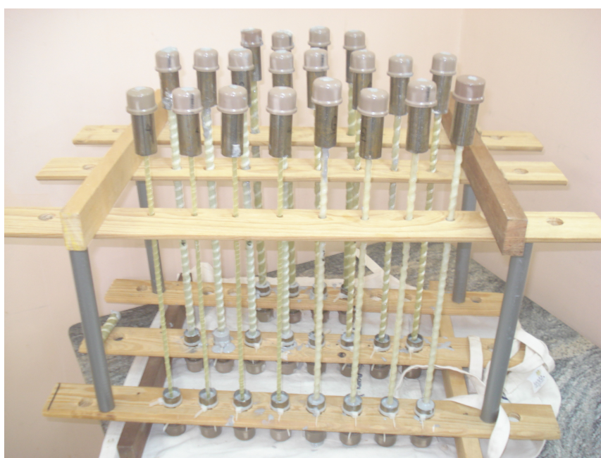
Figura 54 – Cura final da resina de base epóxi
