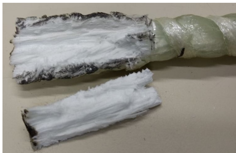
Figura 48 – Amostra Ø10,00mm ensaiada sem ancoragem
