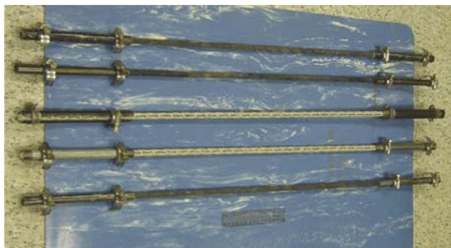
Figura 22 – Barras de FRP com tubos de aço divididos presos nas extremidades
