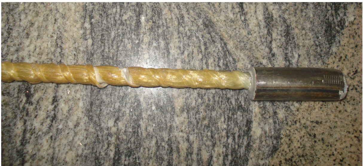
Figura 45 – Amostra 12,5.2 – Modo de falha
