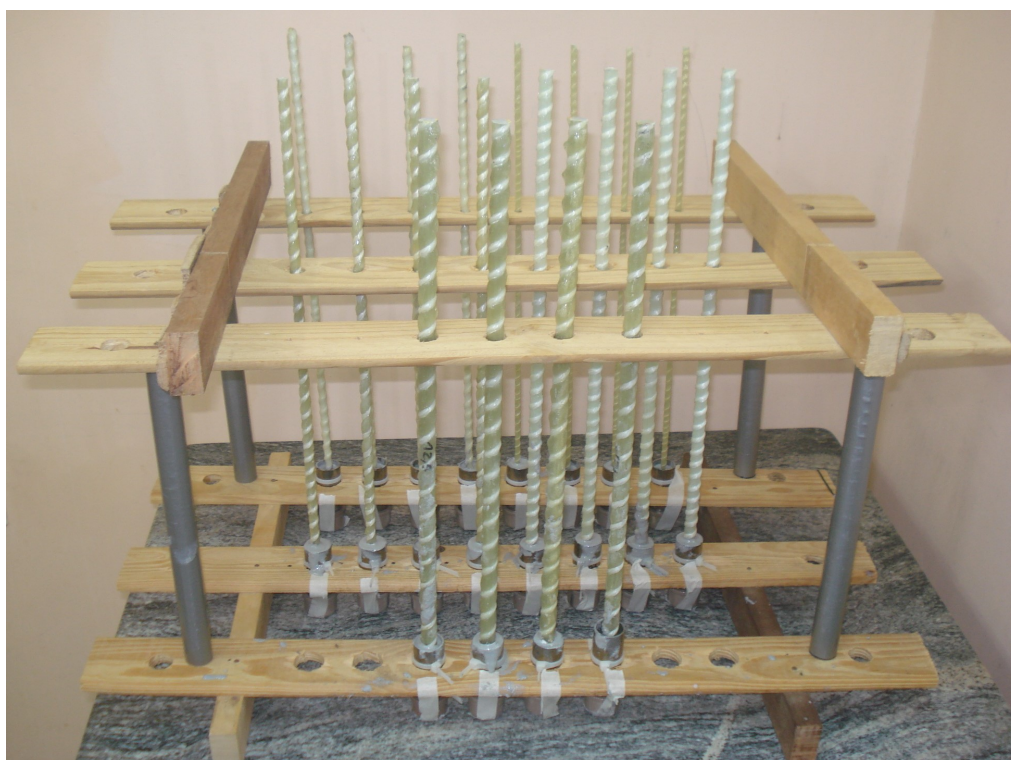
Figura 52 – Estrutura de madeira para alinhamento da ancoragem
