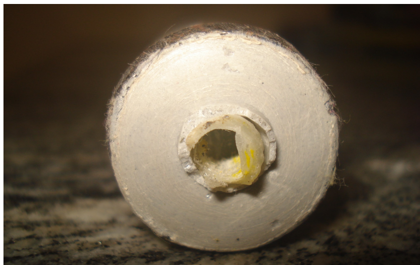
Figura 43 – Amostra 6.2 – Modo de falha
