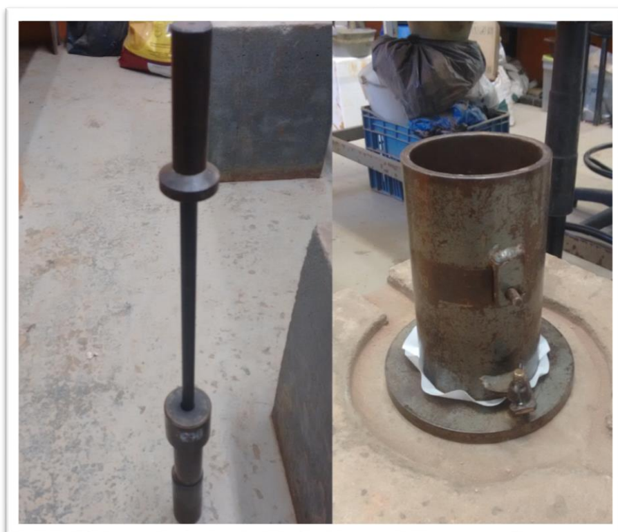
Figura 21 – Ensaio de Compactação
