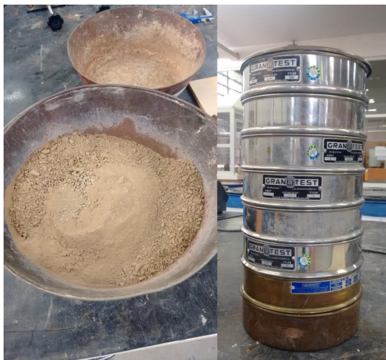
Figura 24 – Peneiramento Agregado Miúdo
