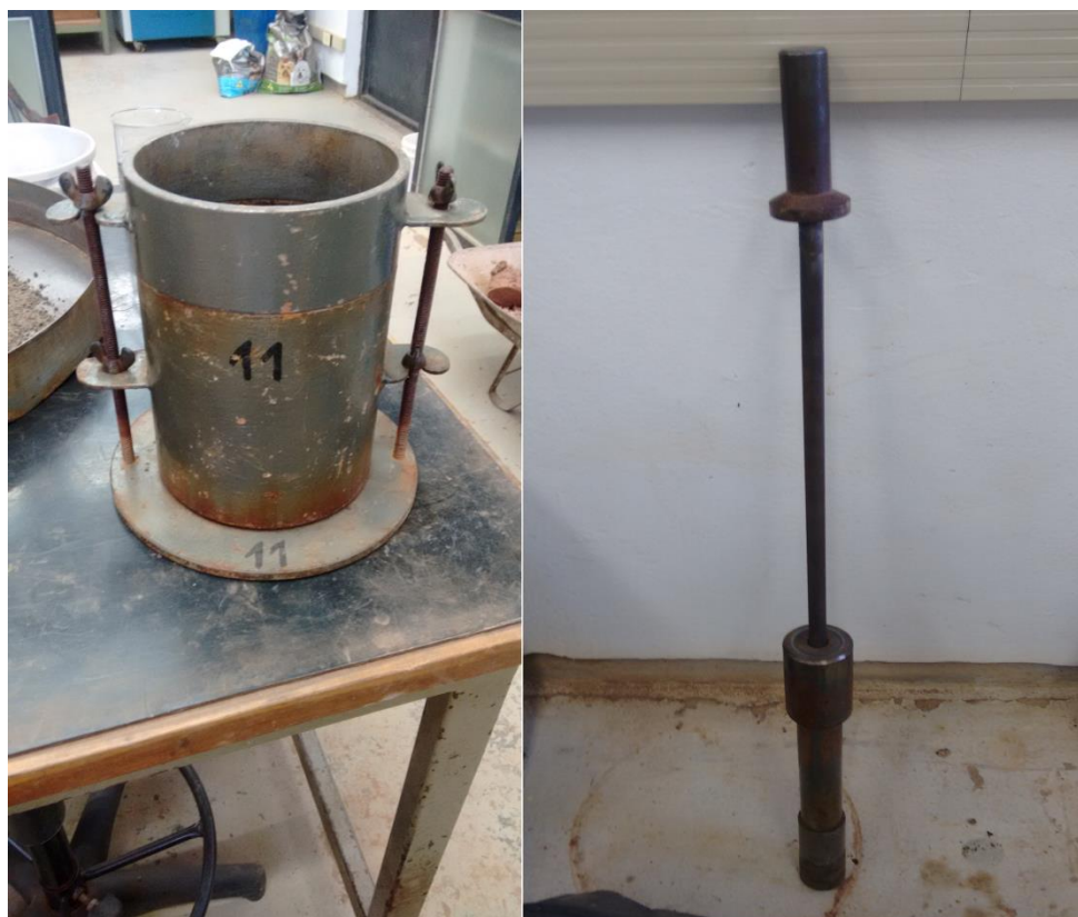
Figura 22 – Ensaio de Índice de Suporte Califórnia
