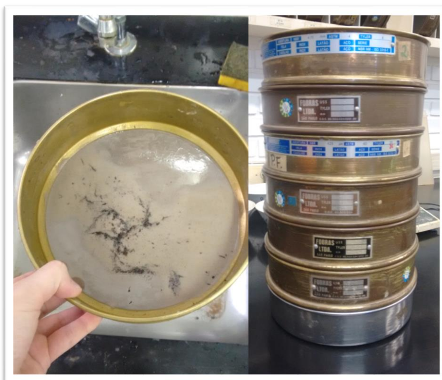
Figura 20 – Ensaio de análise Granulométrica
