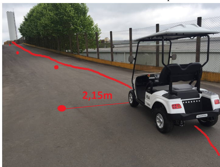
Figura 71: Análise do erro de deslocamento com o ponto da rota criada.
