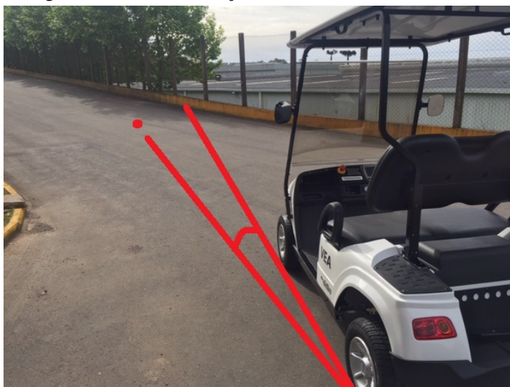
Figura 70: Ângulo calculado da direção do veículo através da bússola eletrônica.
