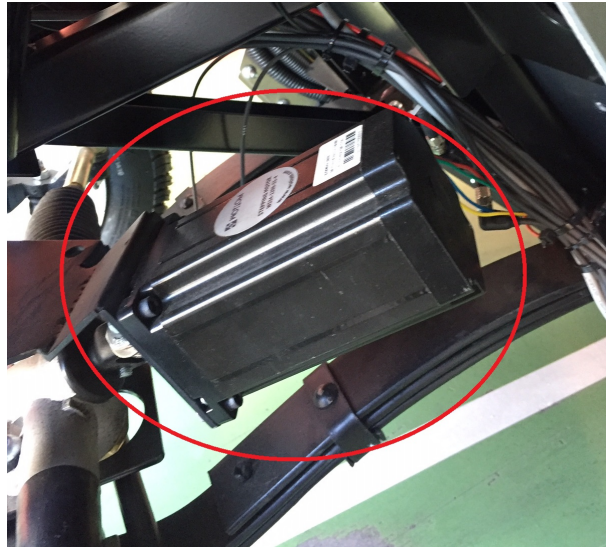
Figura 56: Montagem e fixação do motor de passo no setor de direção do VE.
