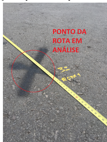
Figura 69: Realização da medição do ponto físico para ser comparado com a coordenada real.
