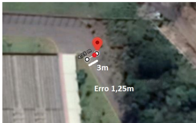
Figura 68: Coordenada Geográfica obtida pelo módulo do projeto comparado com a obtida no Google Maps .
