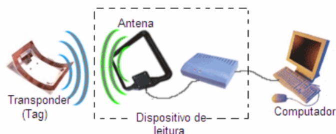
Figura 25: Composição básica da tecnologia Identificação por Rádio Frequência.
