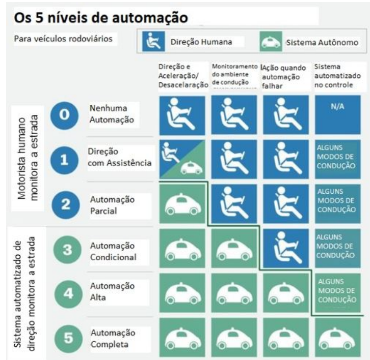
Figura 10: Classificação do nível de automação dos veículos.
