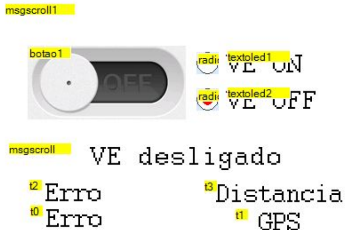
Figura 64: Identificação dos elementos no software de desenvolvimento Nextion.
