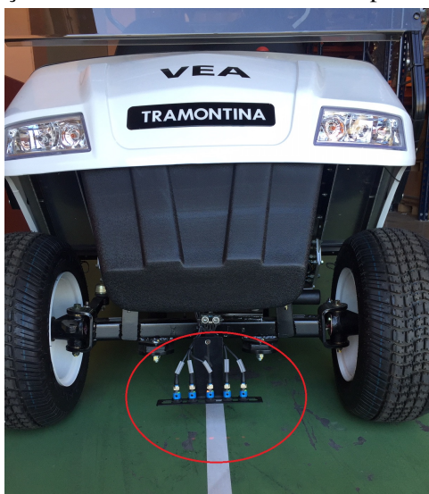
Figura 51: Instalação dos sensores infravermelho na parte frontal do veículo.
