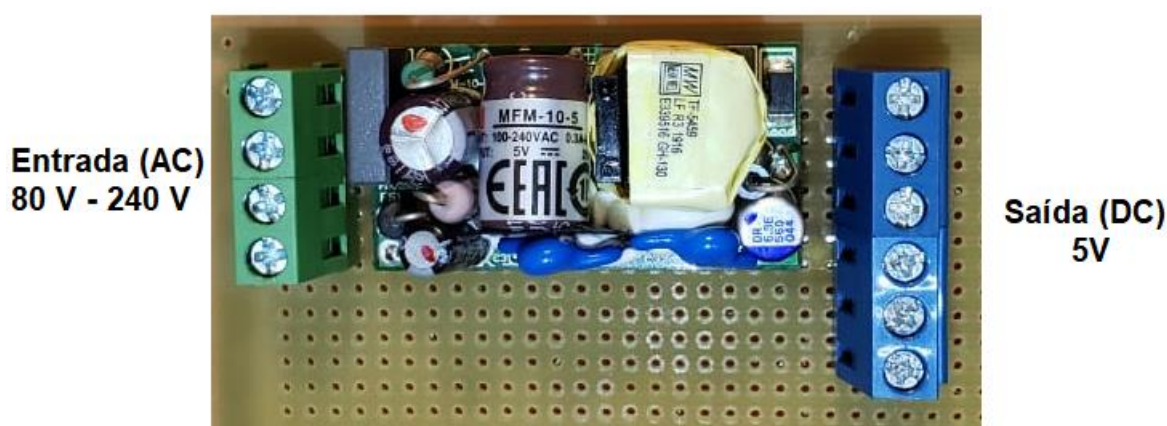
Figura 53 - Circuito montado em placa padrão com o conversor MFM-10-5
