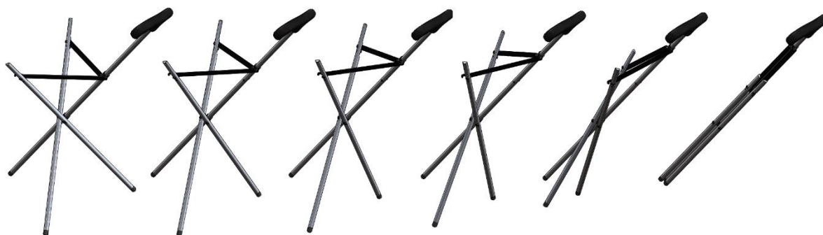
Figura 39 - Estudo de movimento dos componentes
