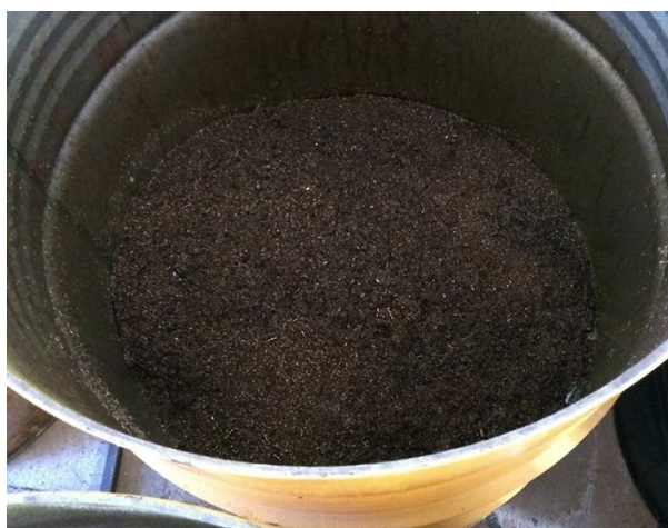
Fotografia 11 – Mistura de granalha de aço e restos de peças estampadas
