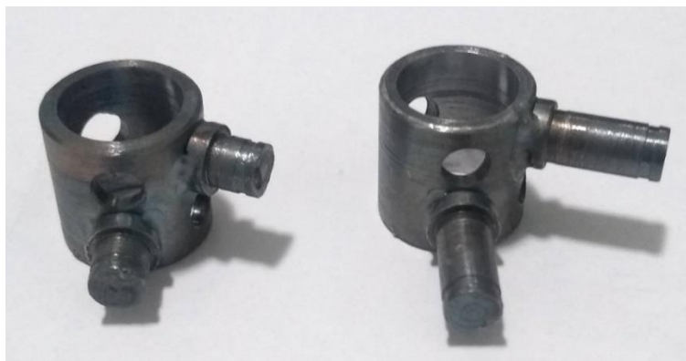
Fotografia 2 – Suporte fixo e suporte deslizante soldados
