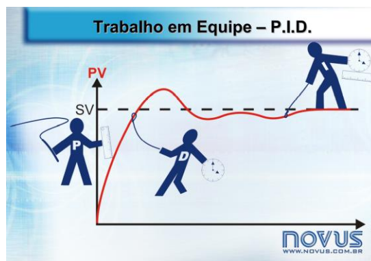
Figura 9 – Trabalho em conjunto dos componentes do controle PID
