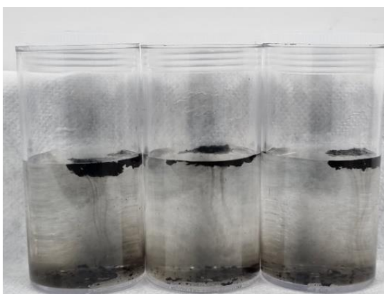
Figura 48- Processo de erosão de scaffolds de PLA 20%
