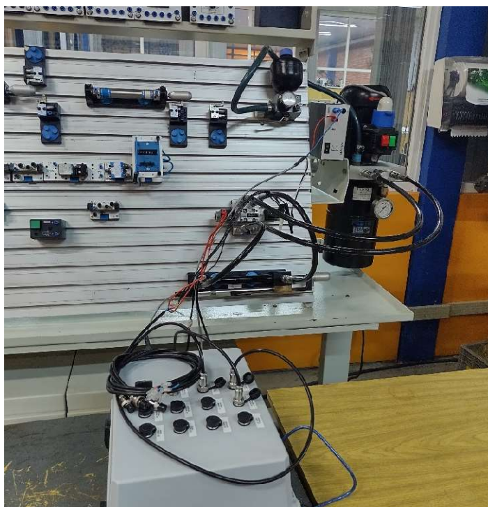
Figura 55 - Montagem do Sistema Hidráulico.
