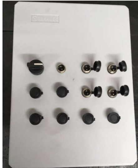
Figura 48 – Conectores do painel elétrico.
