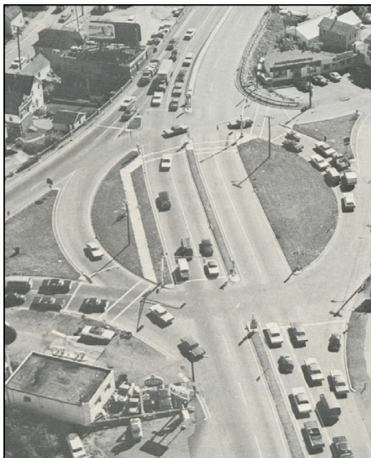
Figura 13 – Interseção tipo rótula vazada
