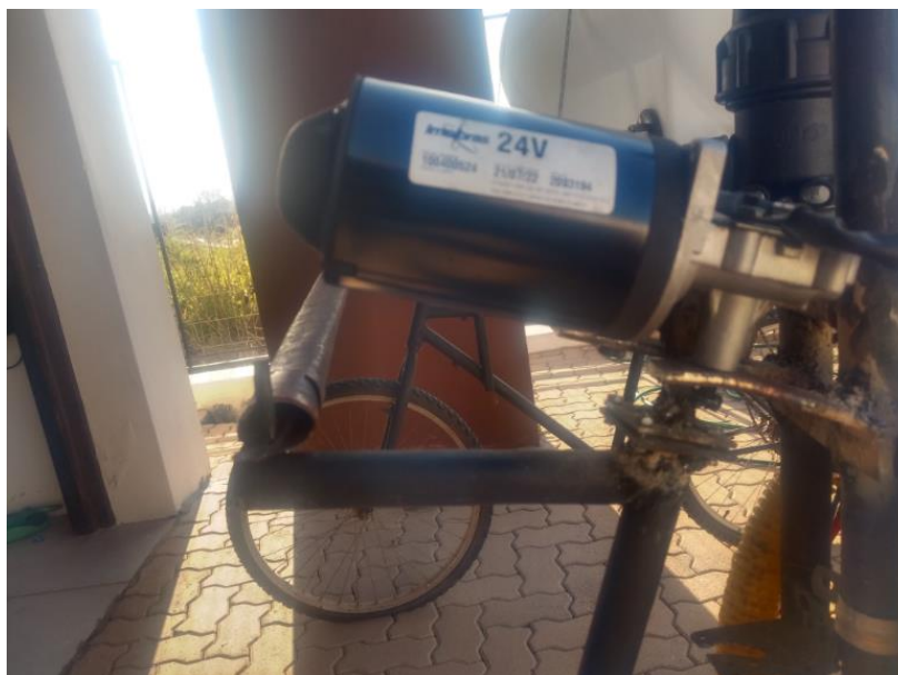
Figura 42 – Montagem do sistema de direção
