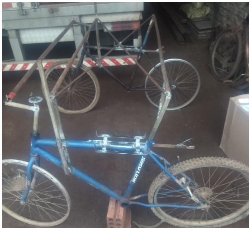
Figura 38 – Montagem do Chassi
