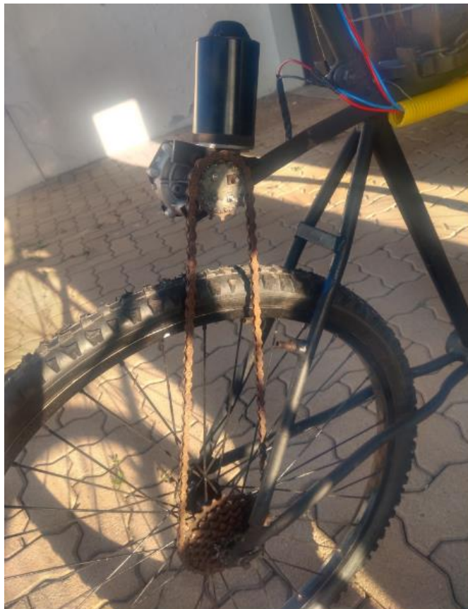
Figura 40 – Montagem do sistema de tração
