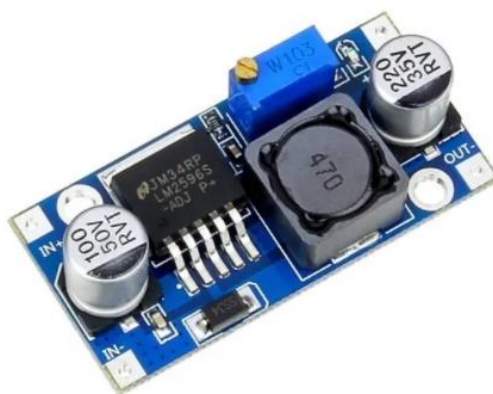
Figura 23 - Regulador de tensão LM2596
