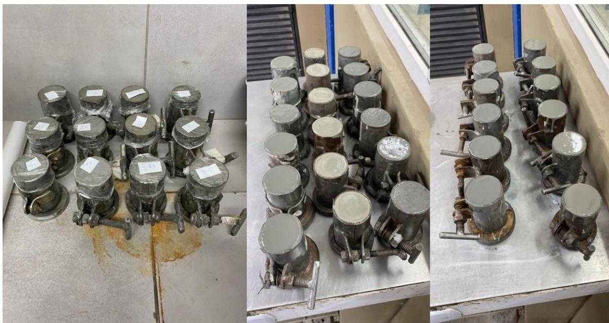
Dos 6 corpos-de-prova moldados, 3 foram levados à câmara úmida com umidade relativa  $\sim 100\%$  e temperatura de  $23\pm 2^\circ\text{C}$ , e 3 foram levados à cura úmida com água aquecida a  $60^\circ\text{C}$ , sendo mantidos sob cura até a idade indicada para caracterização da resistência à compressão. Na Figura 23, pode-se observar os tipos de cura: a) úmida em de  $23\pm 2^\circ\text{C}$  e b) úmida aquecida em  $\sim 60^\circ\text{C}$ .
