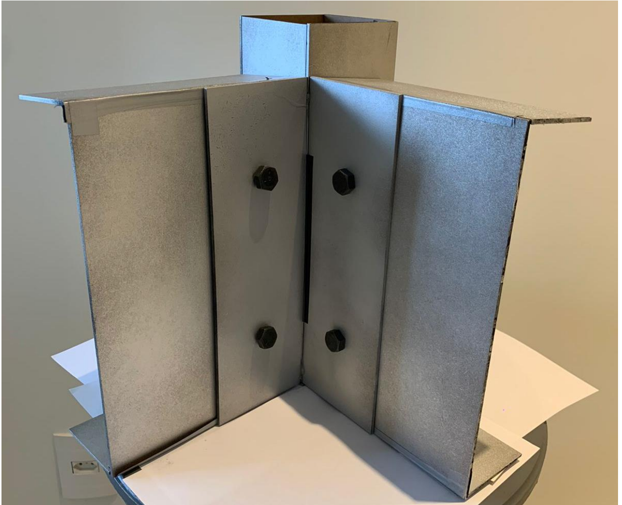
Figura 43 - Modelo Lawson - detalhe extremidade interna da estrutura.
