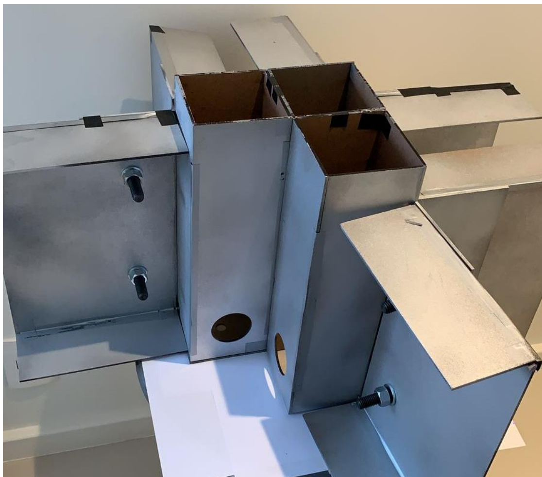
Figura 47 - Modelo Lawson - detalhe posicionamento horizontal de três módulos volumétricos.
