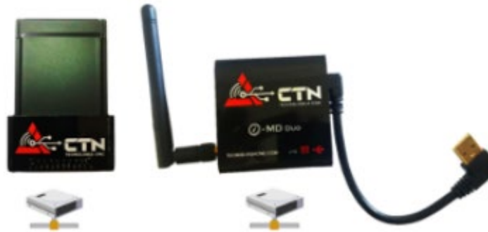
Figura 6 - dongle desenvolvido pela empresa CTN Tecnologia CNC®.
