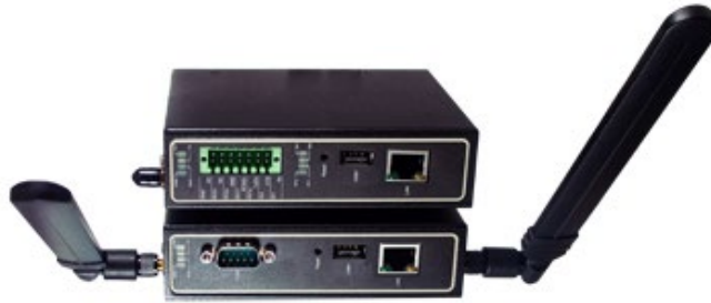
Figura 7 - Gateway desenvolvido pela empresa Atop Technologies®.
