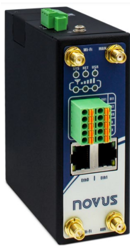
Figura 8 - Roteador VPN industrial para rede celular desenvolvido pela Novus®.
