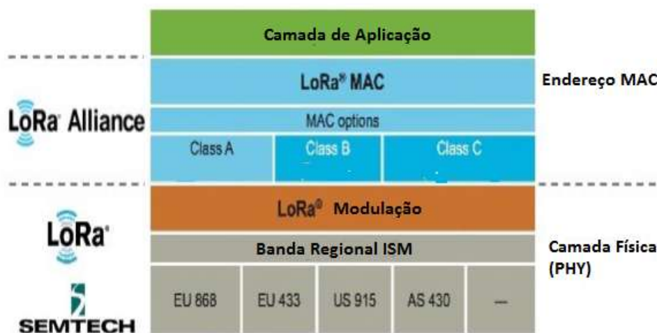
Figura 6 – Camadas do Protocolo LoRaWAN
