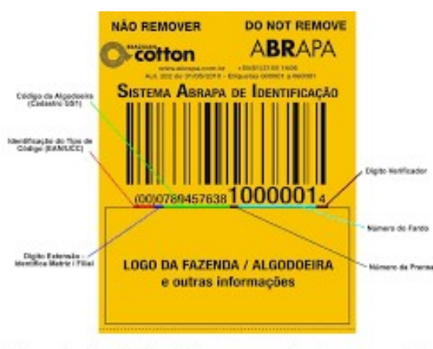
Figura 36 – Sistema ABRAPA de identificação de fardos de algodão
