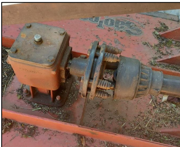
Fotografia 4 – Embreagem de disco utilizada entre cardan e implemento agrícola
