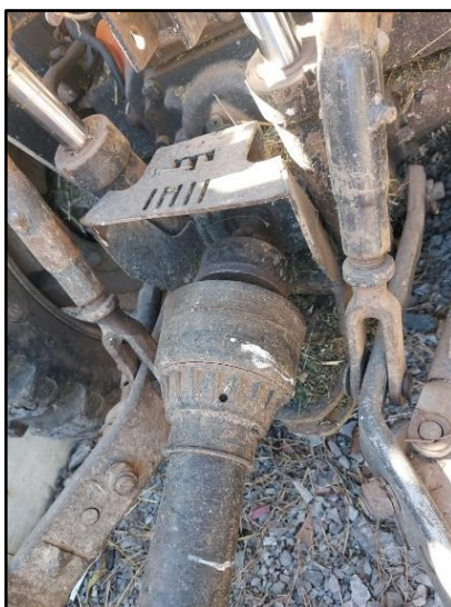
Fotografia 3 – Espaço disponível para aplicação do acoplamento
