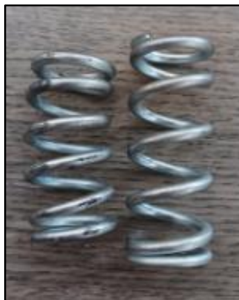
Fotografia 12 – Comparativo antes x depois teste molas originais
