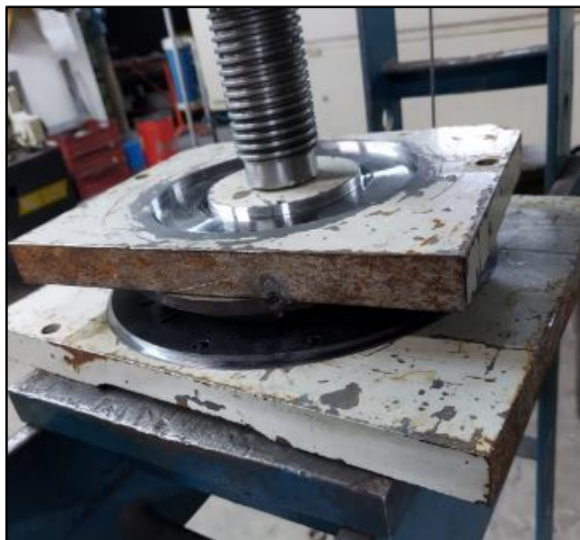
Fotografia 8 – Processo de conformação à frio utilizando prensa hidráulica manual
