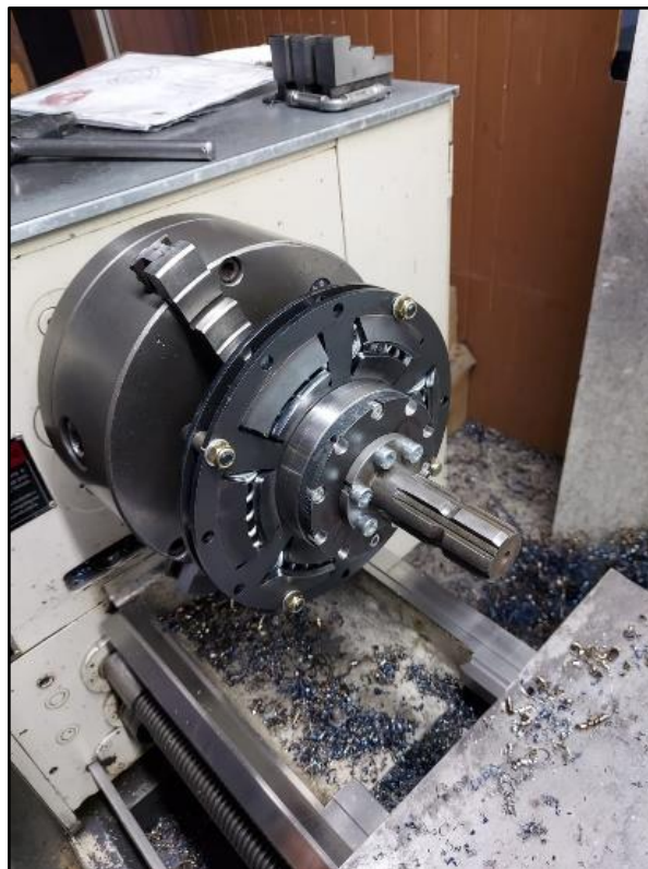
Fotografia 10 – Análise de balanceamento do conjunto em torno à 540RPM
