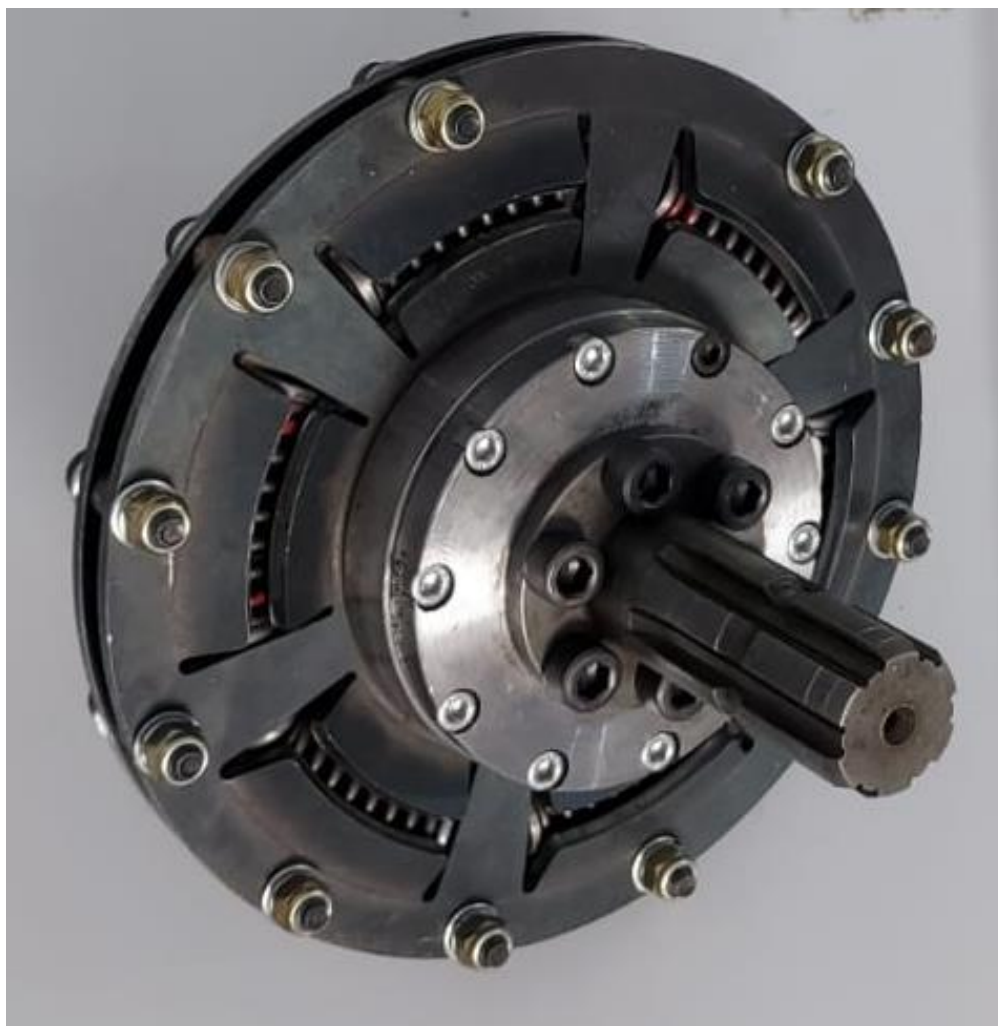
Fotografia 14 – Acoplamento complacente após execução e testes – vista traseira
