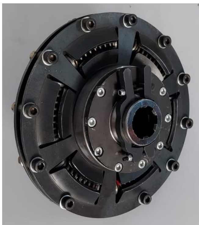
Fotografia 13 – Acoplamento complacente após execução e testes – vista frontal
