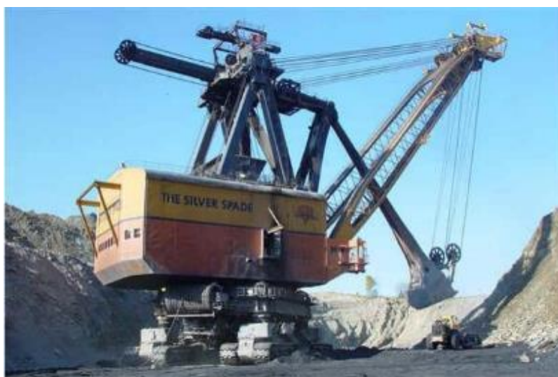
Figura 10 – Escavadeira modelo Silver Spade construída pela empresa Bucyrus
