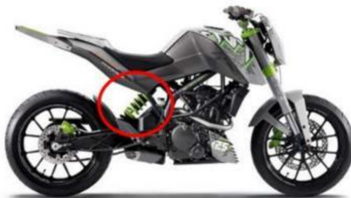
Figura 6 – Motocicleta com sistema de suspensão monochoque (destacado pelo círculo vermelho)
