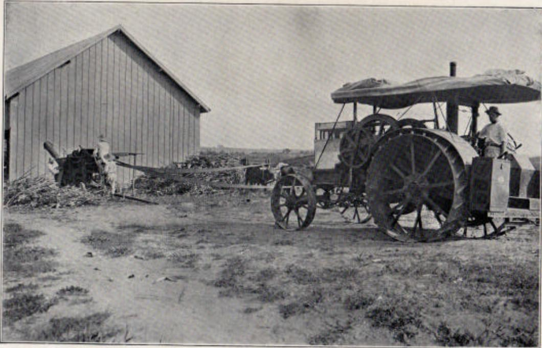
Estação Experimental — Tractor accionando uma descascadora
