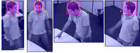
Figura 3.4 – Exemplos do bounding-box da pessoa detectada em diferentes quadros da seqüência de vídeo. A linha amarela mostra os valores dos vetores \mathbf{X}^{\min} e \mathbf{X}^{\max} para a área do busto. A linha vermelha ilustra os valores médios entre os dois vetores, e o quadro rosa é o resultado do refinamento da região da cabeça.
