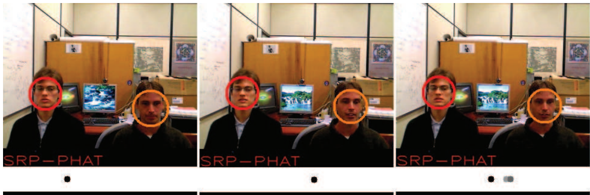
Figura 5.5: Sequência de vídeo para análise da localização pelo áudio utilizando o SRP-PHAT. Na primeira imagem o locutor da esquerda é corretamente localizado pelo algoritmo, na segunda imagem o locutor da direita é localizado. Na terceira imagem, devido a reverberação do ambiente, a localização ficou incorreta.
