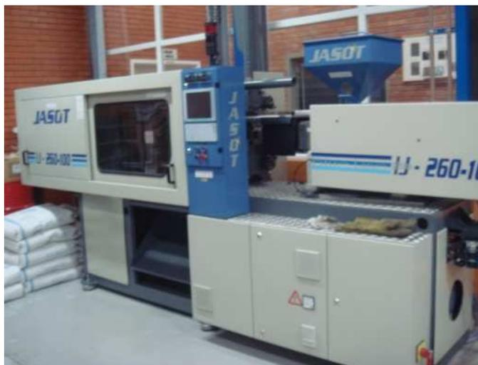
Figura 30 - Injetora Jasot IJ-260-100 instalada
