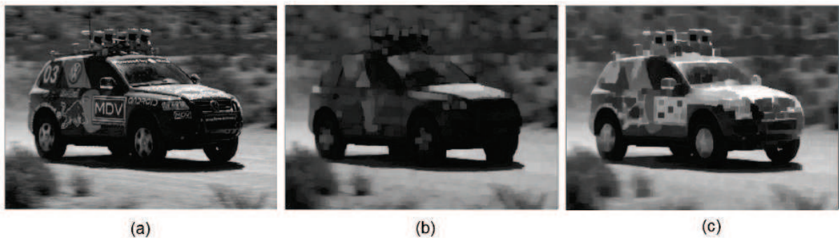
Figura 2.5: (a) Imagem original; (b) resultado da abertura; (c) resultado do fechamento. (De Bradski e Kaehler (2008)).
