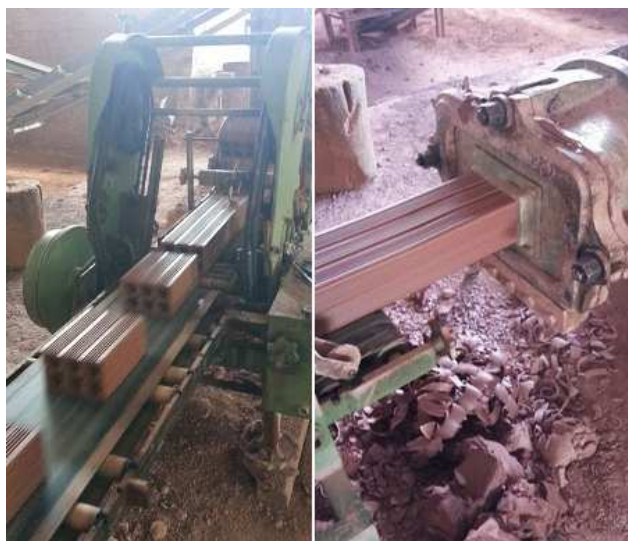
Figura 15 – Blocos de argila após a extrusão
