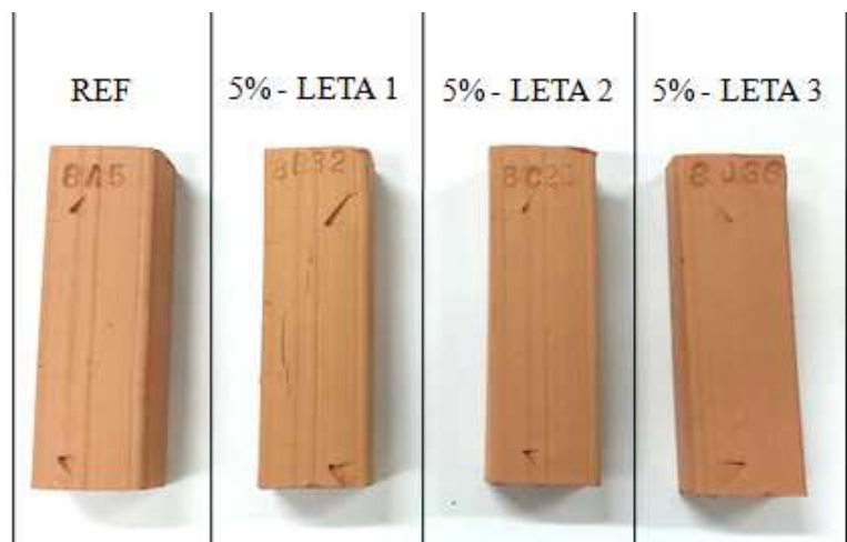
Figura 30 – Cores dos corpos de prova sinterizados a 800°C
