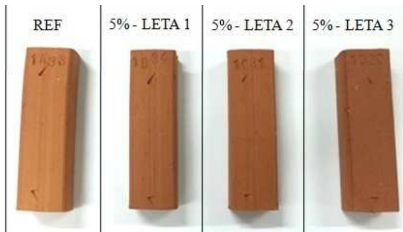
Figura 32 – Cores dos corpos de prova sinterizados a 1050°C
