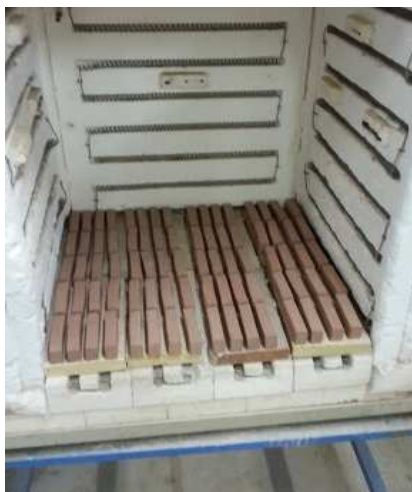
Figura 22 – Corpos de prova dispostos dentro do forno mufla para sinterização
