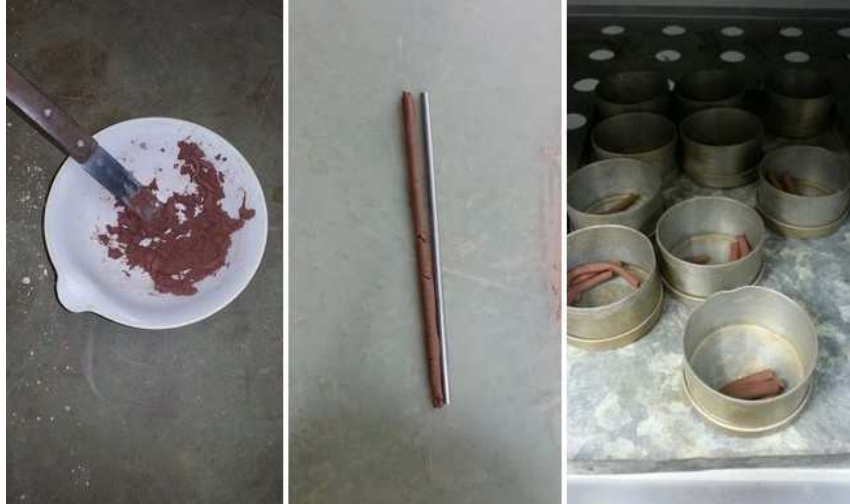
Figura 16 – Etapas do ensaio de limite de plasticidade
