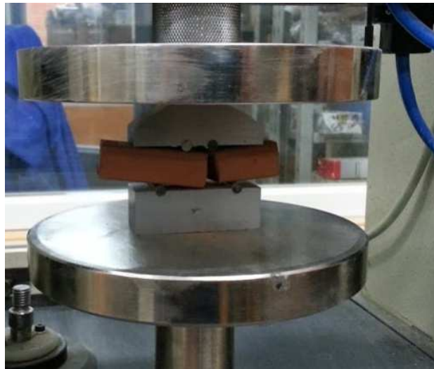
Figura 23 – Ensaio de resistência à flexão – rompimento de corpo de prova
