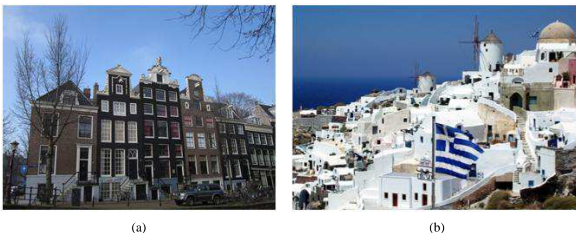
Figura 3 – Predomínio de cores nas edificações: (a) escuras, de alta absorvância, na Holanda, (b) claras, de baixa absorvância, na Grécia.
