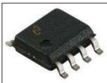
Figura 16 - Exemplo de componente SMD
