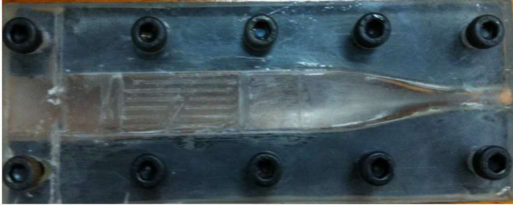
Figura B4 – Alternativa para conter os vazamentos do primeiro modelo da seção de visualização.
