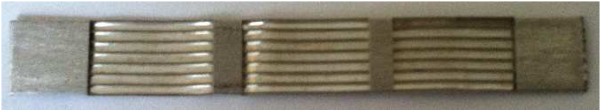
Figura B1 – Teste de corte da parede superior
