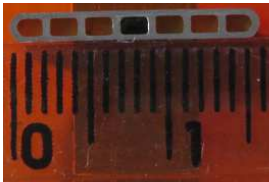
Figura 3.3 – Imagem real do perfil do tubo de multi mini canais paralelos
