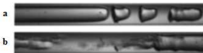
Figura 2.11 – Escoamento intermitente: a) slug ; b) slug /semianular. Fonte: REVELLIN e THOME (2007).
