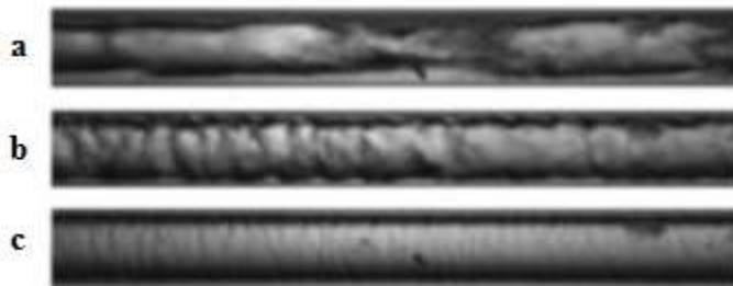
Figura 2.12 – Escoamento anular: a) semianular; b) anular agitado; c) anular. Fonte: REVELLIN e THOME (2007).
