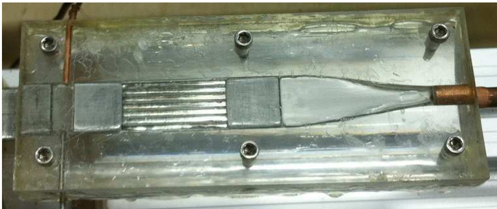
Figura B3 – Primeiro modelo da seção de visualização feito em acrílico
