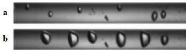
Figura 2.10 – Escoamento borbulhado: a) bolhas dispersas; b) transição bolhas/ plug . Fonte: REVELLIN e THOME (2007).
