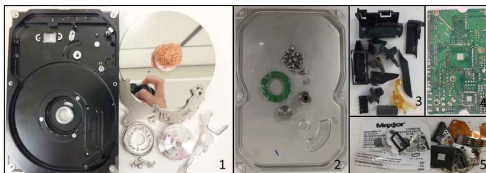
Figura 19 – Segregação do HD por tipo de material: 1 – Metais não ferrosos, 2 – Metais ferrosos, 3 – Plásticos, 4 – Materiais com substâncias de interesse, 5 – Outros materiais.
