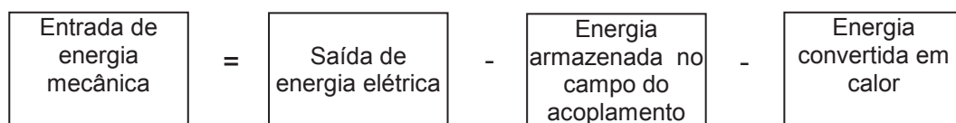
Figura 3.1 - Sistema eletromecânico de conversão de energia (FITZGERALD, 1961).
