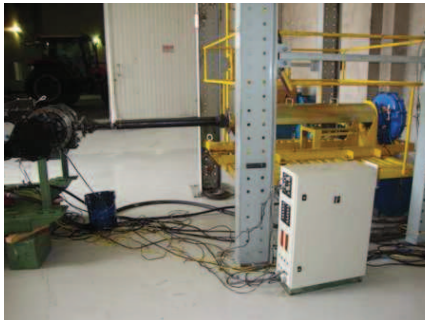
Figura 2.9 – Detalhe do acoplamento do dinamômetro na bancada de teste
