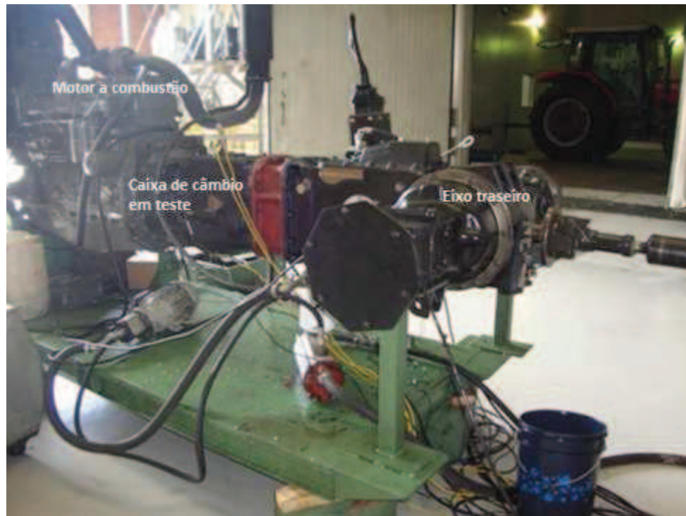
Figura 2.8 - Bancada de teste caixa de câmbio hidráulica acionada por motor a combustão
