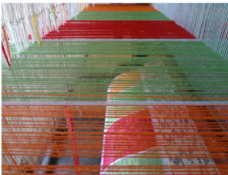
Fotografia 46 – Fios sendo tramados. Resende Costa/MG/BR
