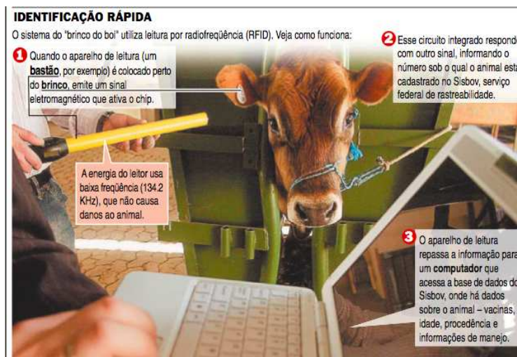
FIGURA 18 – Esquema de funcionamento do chip do boi Fonte: Jornal Zero Hora (2009)
