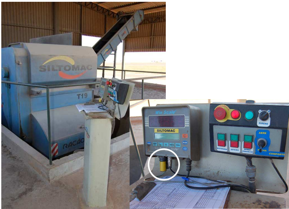
FOTO 5 – Balança eletrônica com pen drive (destaque) no Confinamento Macaé Fonte: Autora
